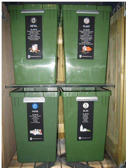
Figur 2 Brug af kassetter i Albertslund Kommune til genanvendelige tørre fraktioner. Kasette har et volumen på 29 liter og udvendige mål er 265 x 375 x 400 mm. Håndtaget er specialfremstillet. Foto: Albertslund Kommune.
